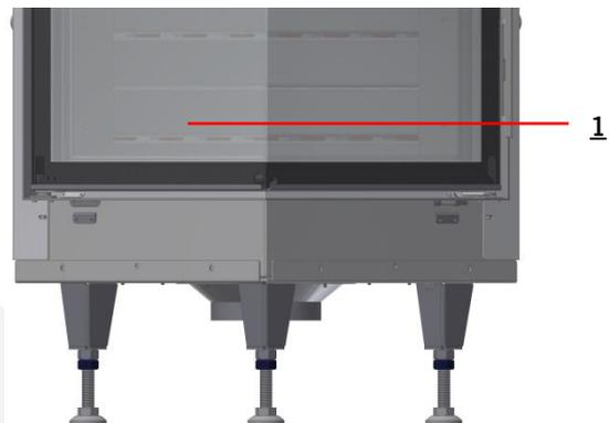
Die Anlage muss regelmäßig, jedoch mindestens einmal pro Jahr, gereinigt werden. Entfernen Sie rechtzeitig, je nach Intensität der Benutzung die Asche. Dieses ist unbedingt durchzuführen wenn die Aschenhöhe die halbe Höhe zwischen Feuerraumtürunterkante und Feuerraumboden erreicht hat.
