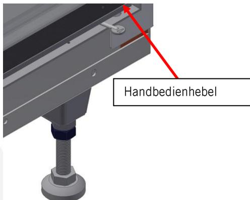
Der Bedienhebel ist in seiner Funktion gekennzeichnet.
